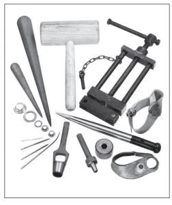
Spleißwerkzeuge (Marlspieker, Holzfitt, Kleidkeule, Spleißklemme), um Seile einsatzfähig zu machen oder zu erhalten. Planenösen, Locheisen und Stanze, Nadeln, Spezialhandschuhe, um Schutzplanen gebrauchsfähig zu erhalten.
