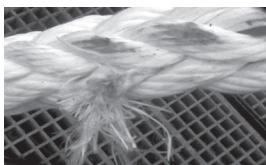
Verknotetes Garn (unvermeidlich bei Litzenfertigung). Kein Schaden.
