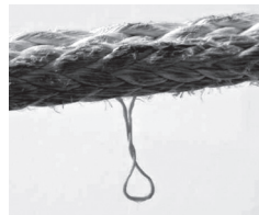
Kein Schaden. Einzelnes herausgezogenes Garn. Reparabel.
