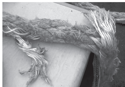
Mehr als die Hälfte der Garne einer Litze zerschnitten.
