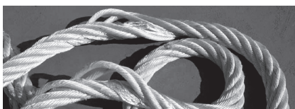
Gebrauchtes Seil. Pelzige Oberfläche. Kein Schaden.
