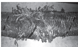
Beschädigtes Mantelgeflecht. Reparabel, wenn Kern unversehrt.
