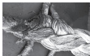
Beschädigte Spleißverbindung. Nicht reparabel ohne Kürzen.
