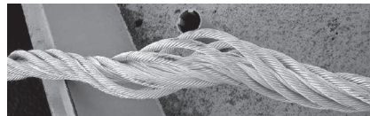
Kein Schaden. Einzelnes herausgezogenes Garn. Reparabel.
