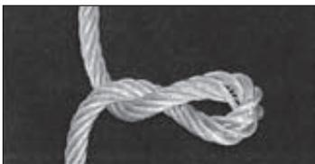
Seil im seilzudrehenden Sinn verdreht. Im unbelasteten Zustand bildet das Seil eine Schlaufe im seilaufdrehenden Sinn. Wenn in diesem Zustand belastet, bleibt das Seil dauerhaft verformt.
