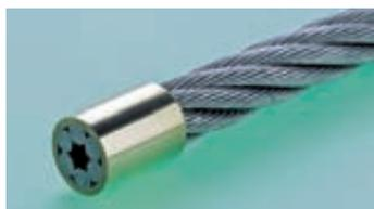
Das Seilgewicht ist definiert als das ungefähre rechnerische Längengewicht kg/m (informativ). Die Seilfestigkeitsklasse ist die Kurzbezeichnung für die Nennfestigkeit der Drähte in N/mm<sup>2</sup>. Die zulässige Grenzabweichung des Seildurchmessers vom Nenn-durchmesser beträgt +8-0% bei 2 bis <4mm, +7-0% bei 4 bis <6mm, +6-0% bei 6 bis <8mm, sowie +5-0% bei 8mm und mehr.
