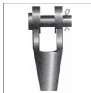
Der Vergußkegel sollte so bemessen sein, dass eine Übertragung der Mindestbruchkraft des Seiles sichergestellt ist. Empfehlung: Der kleinste Kegeldurchmesser sollte mindestens 1.1x Seildurchmesser +4mm betragen.
