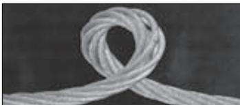
Seil im aufdrehenden Sinn verdreht. Im unbelastetem Zustand bildet das Seil eine Schlaufe im seilzudrehenden Sinn. Wenn in diesem Zustand belastet, bleibt das Seil dauerhaft verformt.
